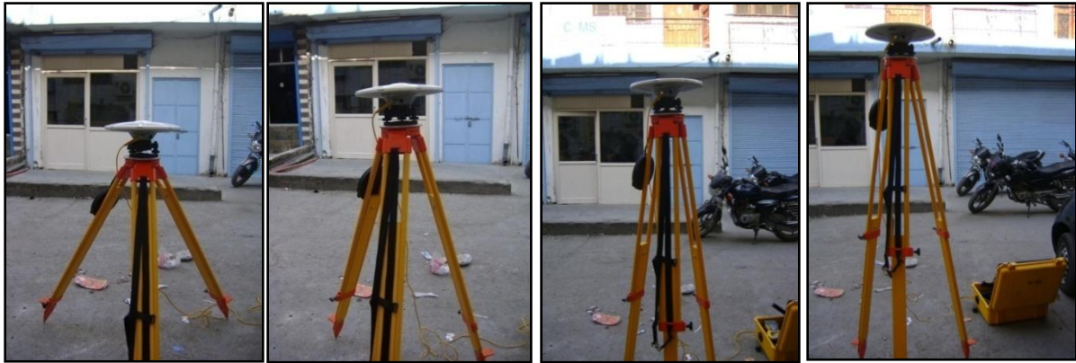
(a) Antenna Height 1 m (b) Antenna Height 1.3 m (c) Antenna Height 1.6 m (d) Antenna Height 1.9 m
